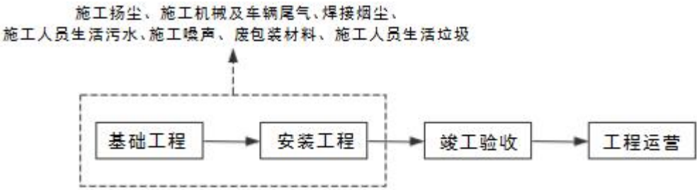
图 3 施工期工艺流程及产污环节图
