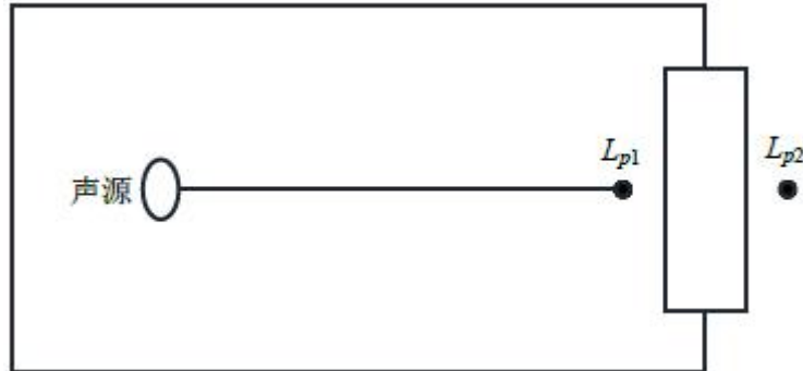
图 5.2-2 室内声源等效为室外声源图例
