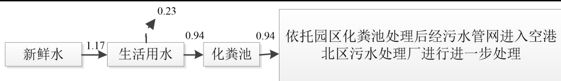
图 2-1 接通市政污水管网后水平衡图 ( \text{m}^3/\text{d} )
