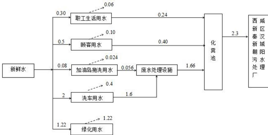
图 2-1 项目水平衡图（按照日用水最大量计，m<sup>3</sup>/d）
