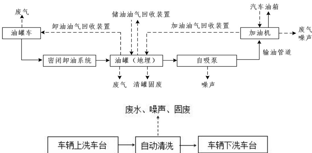
图 2-3 运营期工艺流程及产污节点图
