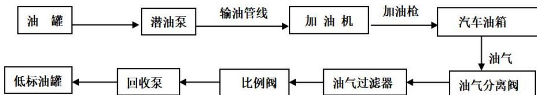
图 2-6 汽油加油工艺流程
